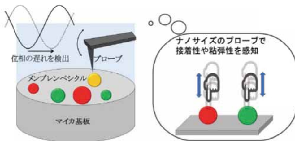
図2. 高速原子間力顕微鏡による位相イメージングの概要図
